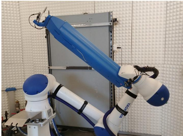
La sonde intensimétrique est embarquée sur un robot collaboratif YASKAWA HC10.
